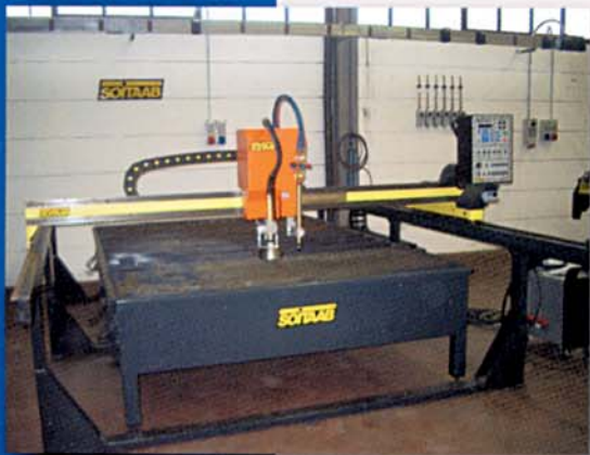
Lineastar con banco di aspirazione fumi
